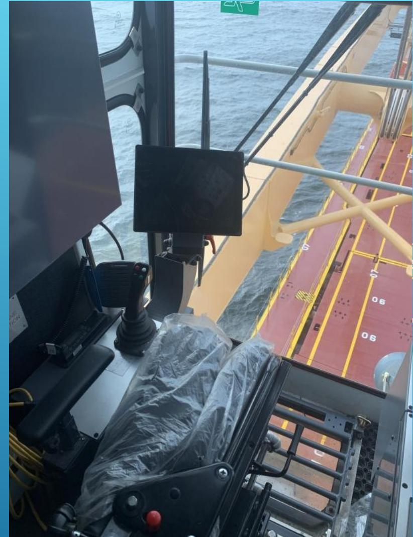
ОТМЕЧУ ЕЩЕ – ТАКОЙ ЖЕ МОНИТОР СТОИТ НА МОСТУ. ОЧЕНЬ УДОБНО, ВСЯ ИНФОРМАЦИЯ НА ВИДУ (ВКЛЮЧАЯ УГЛЫ ПОВОРОТА БАШНИ И НАКЛОНА СТРЕЛЫ И ЕЩЕ КУЧА ВСЯКОЙ ИНФОРМАЦИИ. ВЫСОТУ ПОД ГАКОМ НА РАЗНЫХ ВЫЛЕТАХ МОЖНО ТОЧНО ИЗМЕРИТЬ, ПОКА ГАК ВИРАЕТСЯ – ПОКАЗЫВАЕТ СКОЛЬКО МЕТРОВ)
